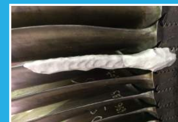
Création d'une empreinte négative en M70. Creation of a negative mould with M70.
