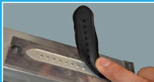
Industrie du Moule : contrôle d'état de surface. Vérification de la validité d'un moule. Mould Industry : surface finish control. Checking the validity of a mould.
