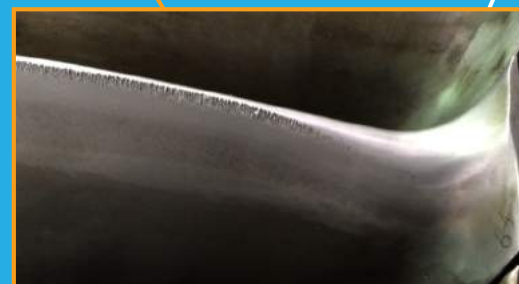
Erosion sur une pale. Erosion on a blade.
