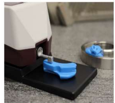
Mesure de rugosité sur une empreinte en P80 Ra
