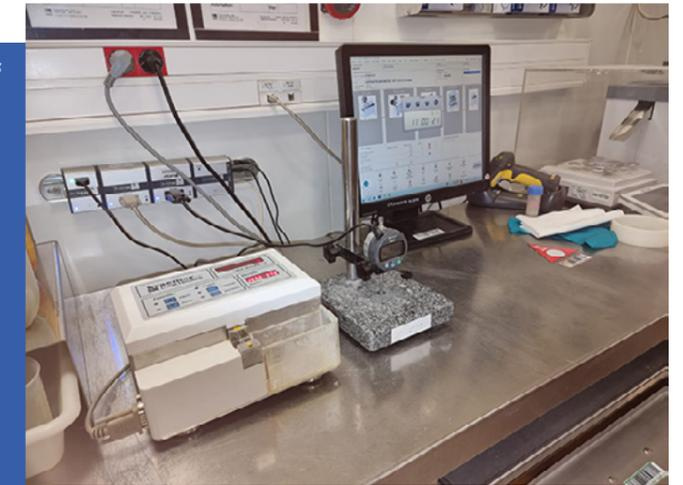
Ce montage de contrôle permet de vérifier plusieurs cotes sur des bielles à l'aide de la mesure pneumatique. Plusieurs paramètres sont contrôlés comme les diamètres intérieurs ainsi que la torsion et le vrillage. Les mesures sont compensées en température.
